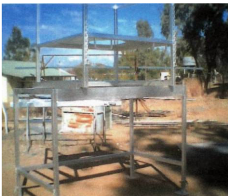
Fig 5. Davis Bag Stand provides the base for a mini silo.
